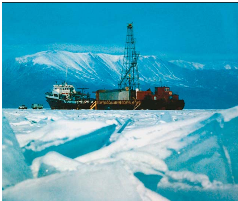
Рис.2. Буровая платформа на барже, вмороженной в лед. Максимальная глубина пробуренных донных отложений Байкала 600 м. Детальное комплексное изучение полученных кернов позволило разработать уникальный пространственно-временной геохронометр и восстановить этапы развития природы за отрезок времени в 8 млн лет (с позднего миоцена).
